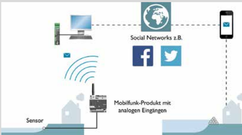
Abbildung 13: Hochwasserfrühwarnsystem, das über ein Social Network alarmiert Quelle: PHOENIX CONTACT, 2013
